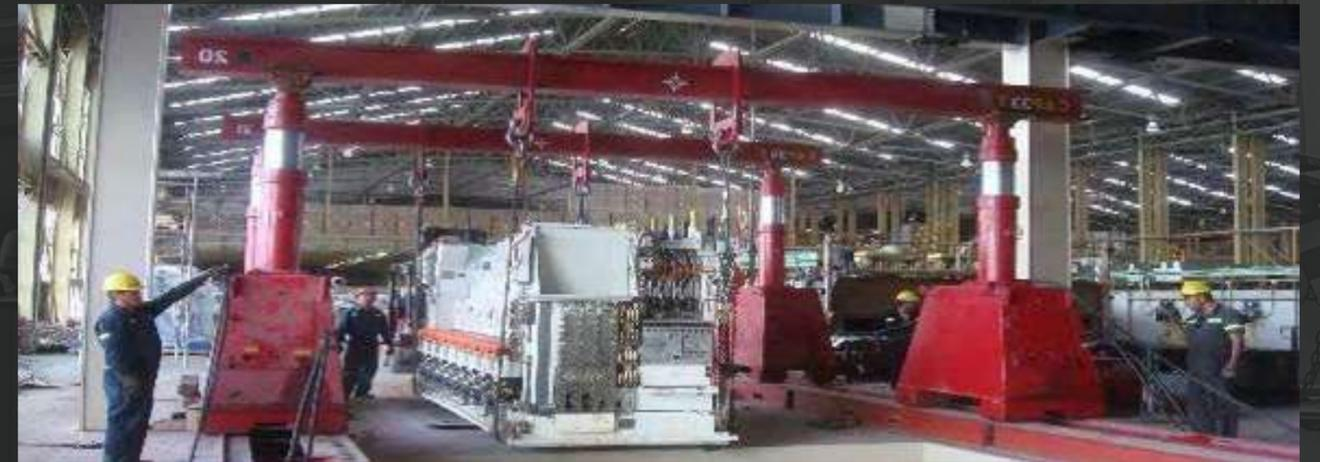
**Cuatro cilindros:** a una altura de 4.61 mts. capacidad máxima de carga 400 tons. A una altura de 8.27 capacidad máxima de carga 200 tons.
