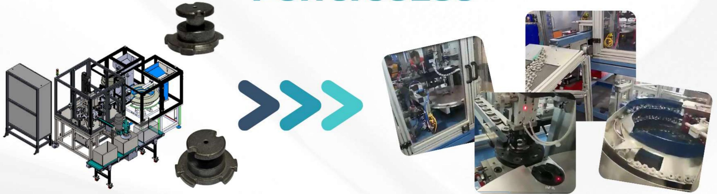
En Ingeniería Mecatrónica LOAR **desarrollamos la primera máquina automática para el ensamble de piezas sinterizadas crudas.** En una sola estación integramos alimentación, alineación y validación dimensional, **logrando ensamblar y verificar una pieza cada 2 segundos** con precisión de +/- 10 micrómetros y eficiencia inigualables.
