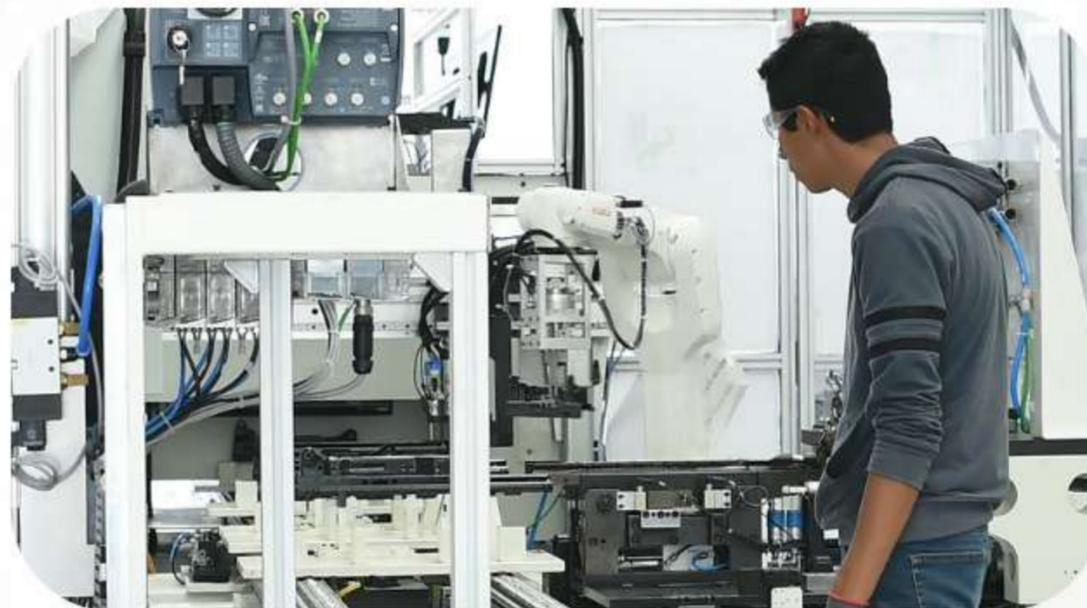
Diseñamos y fabricamos una línea de ensamble especializada para rieles de asientos, **componentes clave en la seguridad estructural de los vehículos. Esta línea garantiza mediante un robot un proceso preciso, controlado y repetible**, asegurando la integridad mecánica de cada pieza mediante estaciones automatizadas de ensamblado, verificación y trazabilidad. **La solución fue desarrollada bajo estándares de calidad exigentes**, cumpliendo con los requerimientos críticos del sector automotriz.
