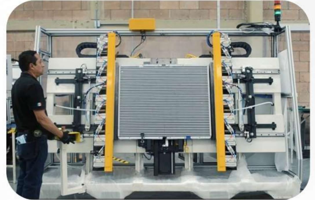
Rediseñamos el proceso de prueba de fuga gruesa en radiadores de camión;
