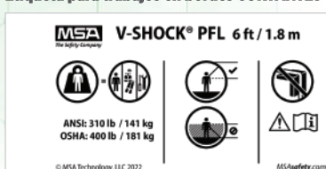
Etiqueta para trabajos en bordes NO CORTANTES
