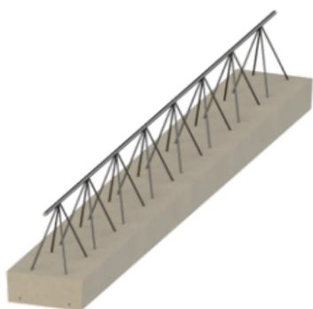
► Elemento estructural compuesto por una armadura de acero y un patín de concreto que sirve para apoyar las bovedillas y como cimbra al colar la losa. La vigüeta provee resistencia a la estructura y permite cubrir claros grandes sin necesidad de columnas. Utilizada en el sistema constructivo de vigüeta y bovedilla.
