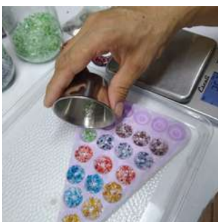
Rellenando moldes con vidrio molido
